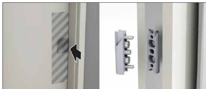
Em caso de emergência, se não puder remover a puxador da porta na parte interna da dobradiça, abra a porta com força, aplicando uma força séria ao redor da área da alça. Com 1 kN de força, o clipe de segurança na trava irá ceder e a porta se abrirá / In the event of emergency, if you cannot remove the door handle on the inside of the hinge, prise open the door, applying serious force around the handle area. With 1 kN of force, the safety clip on the latch will yield and the door will open / En caso de emergencia, si no se eliminó el pador de una maqueta de una parte de la parte interna, se abrió un porta com força, se aplicó a la red a la red de la zona. Com 1 kN de força, o clipe de segurança na trava irá ceder e porta se abrirá.
