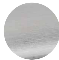
.S Aço inoxidável satinado ou escovado / Satin or brushed stainless steel / Acero inox satinado o cepillado.
